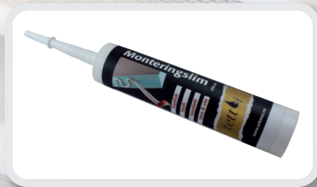
Monteringslim for våtromsplater, 290 ml Fuktherdende 1-komponent lim på SMP basis. Inneholder ikke løsemidler. Brukes til å lime våtromsplater mot alle overflater.
