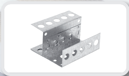
Skjøtestykke 90 grader for våtromsplater Brukes for å stabilisere og forsterke om man skal bygge et hjørne av to plater osv, som stabilisering mens limet herder.
