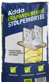
**Adda Ekspanderende Stolpemørtel** er en sementbasert mør tel som brukes til faststøping av søylesko, bolter, stolper ol. Den er selvkomprimerende, og vil sige inn i ujevn heler i hullet fordi den er ekspanderende (ca. 1 - 2 %). Største kornstørrelse er 2,5 mm.
